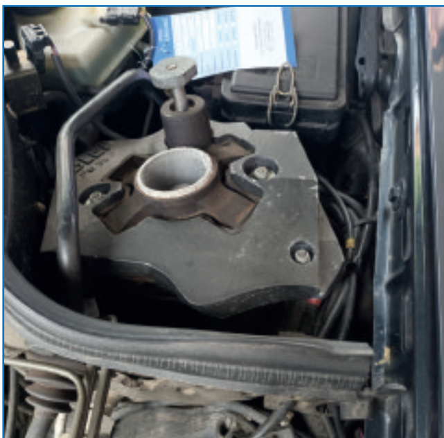
Der im Cabrio verbaute Schwingungstilger sorgt für Stabilität der Karosserie.
