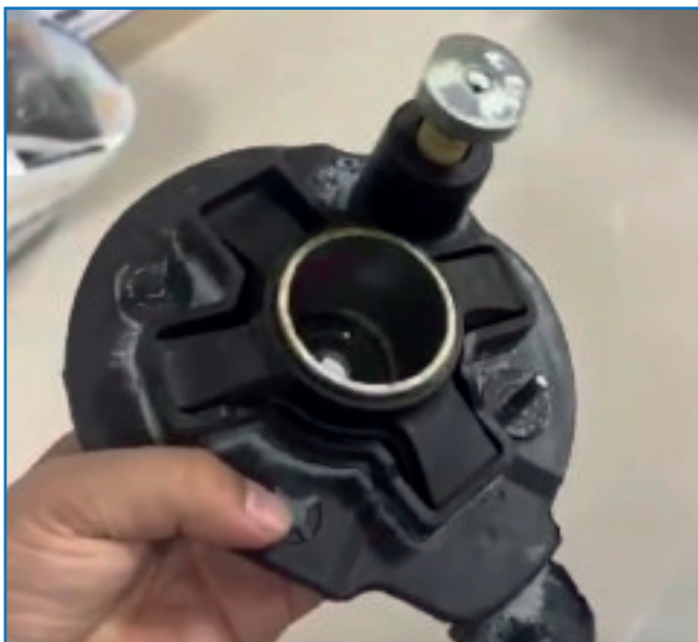
Der ausgebaute Schwingungstilger ohne Bleikörper von oben.
